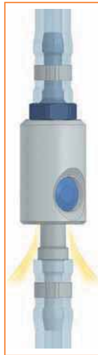
L'about est maintenu dans le raccord : décompression du circuit aval
